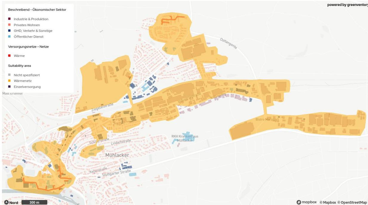
Das bestehende Nahwärmenetz in Mühlacker soll ausgebaut und nachverdichtet werden. Neubaugebiete sollen angeschlossen werden. Es soll geprüft werden, ob ein Transformationsplan nach BEW ausgeschrieben und durchgeführt werden kann.
